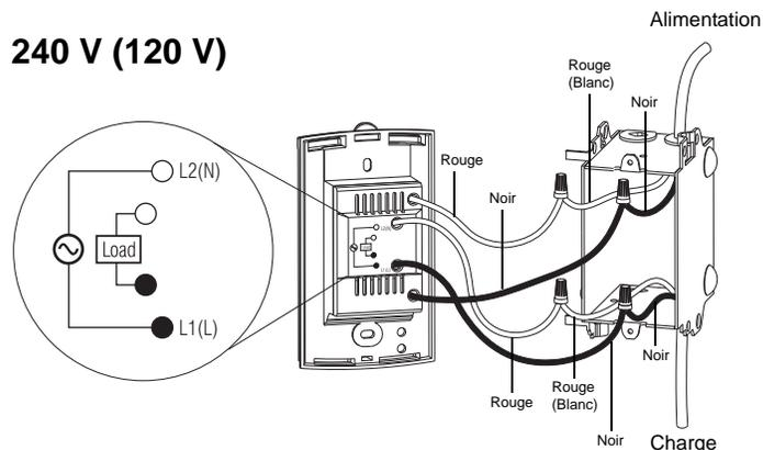
**NOTA :** Tous les câbles et les connexions doivent être conformes au code d'électricité local. Les fils du thermostat qui servent aux raccordements de ligne et de charge sont étamés. Des connecteurs CO/ALR spéciaux doivent être utilisés si ces fils doivent être reliés à des conducteurs d'aluminium.
