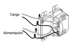
NOTA: todos los cables y conexiones deben respetar el Código de Electricidad local. Los cables del termostato que sirven de conexión a la línea de alimentación y a la carga son de cobre estañado. Si estos cables deben conectarse a conductores de aluminio, deben usarse conectores especiales CO/ALR.
