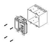
Instalar el termostato en la caja eléctrica con los tornillos provistos.
