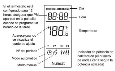
Según la configuración del termostato, la pantalla puede quedar iluminada en p ermanencia o sol amente cuando se o prime cualquier botón (ver la sección 5.1). En el último caso, la pantalla se encenderá durante 12 segundos.
