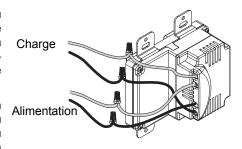
NOTA: Tous les câbles et connexions doivent être conformes au code d'électricité local. Les fils du thermostat qui servent de connexions à la ligne de tension et à la charge sont étamés. Des connecteurs CO/ALR spéciaux doivent être utilisés si ces fils doivent être reliés à des conducteurs en aluminium.
