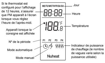
Selon la configuration du thermostat, l'écran peut être rétroéclairé de façon permanente ou lorsqu'on appuie sur n'importe quel bouton (voir la section 5.1). Dans ce dernier cas, l'écran demeurera rétroéclairé pendant 12 secondes.
